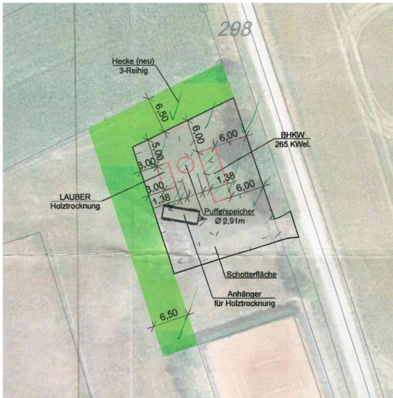
Abb. 17: Heckenpflanzung aus der Genehmigung des bestehende BHKW
